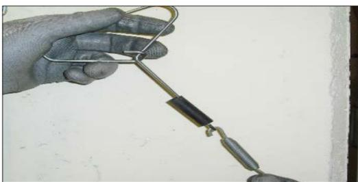
**ITA** Inserire le gomma alle molle lunghe (10) e corte (9) usando il tiramolle (13) in dotazione
