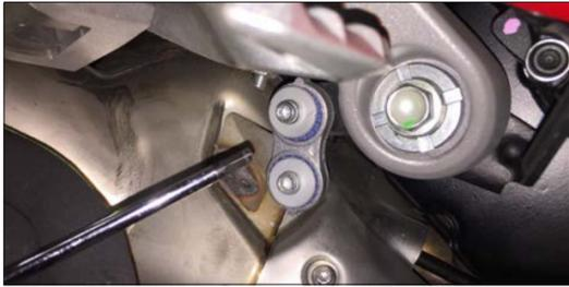
**ITA** Rimuovere la vite di supporto bielletta destra
