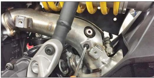
**ITA** Rimuovere la vite destra di supporto paracalore grigio dell'attacco testa verticale
