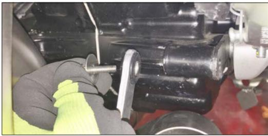
**ITA** Avvitare, dove prima era avvitata la bielletta di serie, la bielletta in dotazione al carter motore senza serrare usando la vite (4) e la rondella (7) in dotazione
