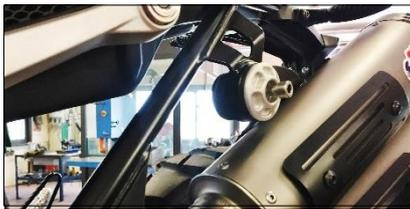
**ITA** Avvitare il silenziatore al telaio usando la vite e la rondella di serie, senza serrare
