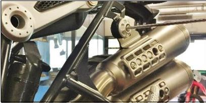
**ITA** Svitare la vite della staffa supporto silenziatore, conservandola per il montaggio del kit Termignoni, e rimuovere lo scarico originale e la fascetta innesto
