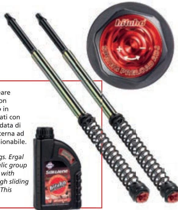
**CARATTERISTICHE TECNICHE** Molle a rigidità lineare in Acciaio legato Cr-Si. Tappo superiore in Ergal con regolazione del precarico molla. Gruppo idraulico in cartuccia pressurizzata ad Azoto. Pistoni maggiorati con smorzamento a doppio effetto. Confezione corredata di olio Synt FUCHS-Silkolene per la lubrificazione esterna ad alta scorrevolezza. Prodotto completamente revisionabile.
