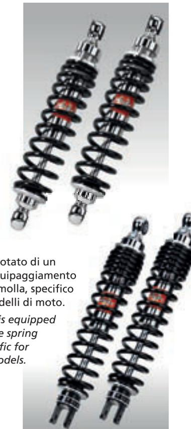
**N.B.** WGE è dotato di un particolare equipaggiamento del precarico molla, specifico per alcuni modelli di moto.
