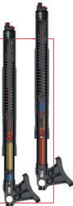
Le regolazioni si trovano tutte sulla parte superiore della forcella: precarico molla idraulico; estensione e compressione sono distinte nelle due cartucce.
