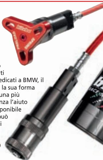
La vaschetta di compensazione è separata del corpo per un migliore raffreddamento del fluido e per maggiore libertà di posizionamento. E' collegata da un tubo flessibile per altissime pressioni in treccia metallica rivestita per migliorare la risposta dell'ammortizzatore aumentando il grip ed il comfort.
