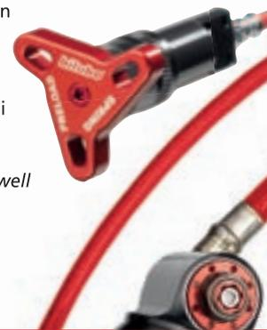
La vaschetta di compensazione è separata del corpo per un migliore raffreddamento del fluido e per maggiore libertà di posizionamento. E' collegata da un tubo flessibile per altissime pressioni in treccia metallica rivestita per migliorare la risposta dell'ammortizzatore aumentando il grip ed il comfort.
